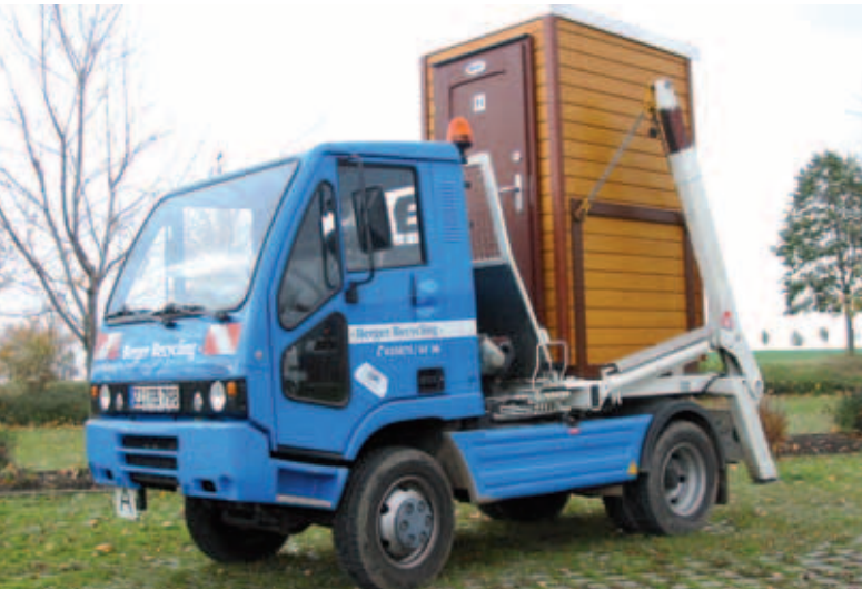
Das neueste Modell, eine Chemie-Toilette für alle kleineren Stellorte, wurde speziell für Multicar-Containeraufnahmen produziert, um sie transportabel zu machen.
